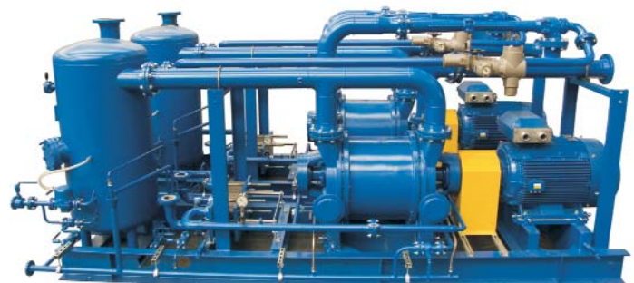
In caso di basse pressioni del condensatore e di acqua di raffreddamento calda: pompa per vuoto ad anello liquido monostadio con eiettore ad aria
