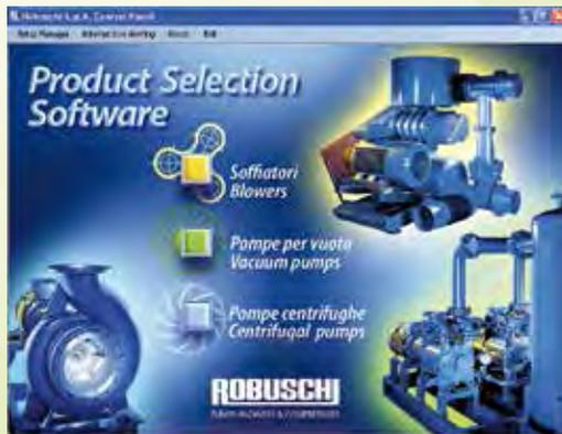
Robuschi a créé un programme de sélection spécifique pour déterminer les **paramètres de fonctionnement** des pompes à vide à anneau liquide, en fonction des **conditions d'installation**, telles que la **pression et la température d'aspiration**, le **débit**, l'**humidité du gaz aspiré** et la **température de l'anneau liquide**.
