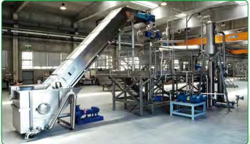
Lebensmittelindustrie: Vakuumpumpen im Einsatz in der Schälphase von Gemüse im Agroindustrie-Bereich.
