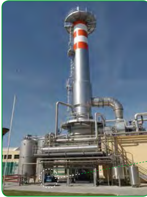
Lebensmittelindustrie: Vakuumpumpen für Multi-Effekt-Verdampfungsprozesse in Anlagen zur Fruchtsaftherstellung.
